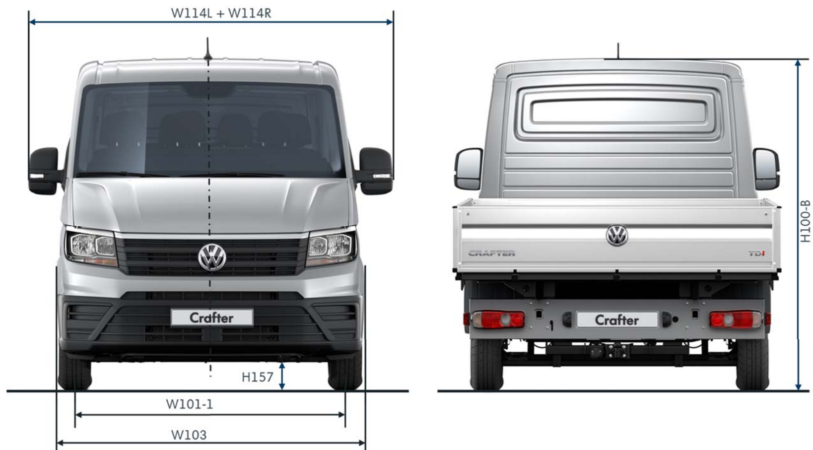
Obr. 3: Rozměry vozidla Doka – valník / pohled zředu a zepředu
