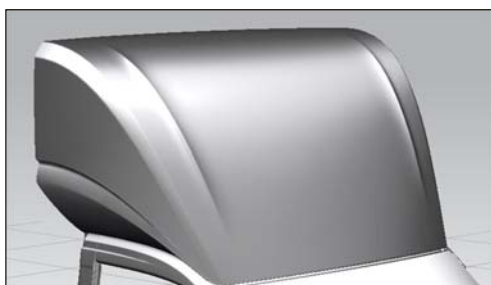
Střešní spoiler (YTD)
