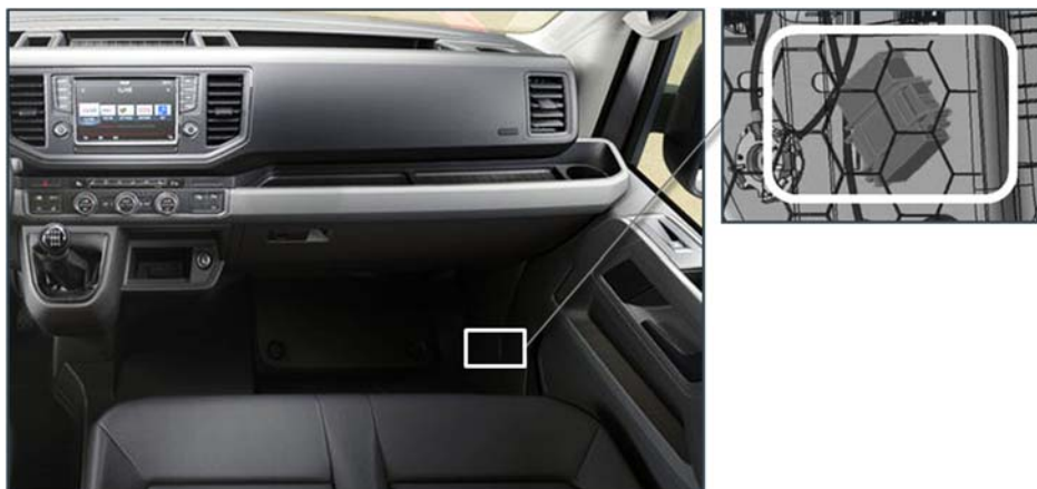
Svorkovnice (IS1) za obložěním A sloupku dole
