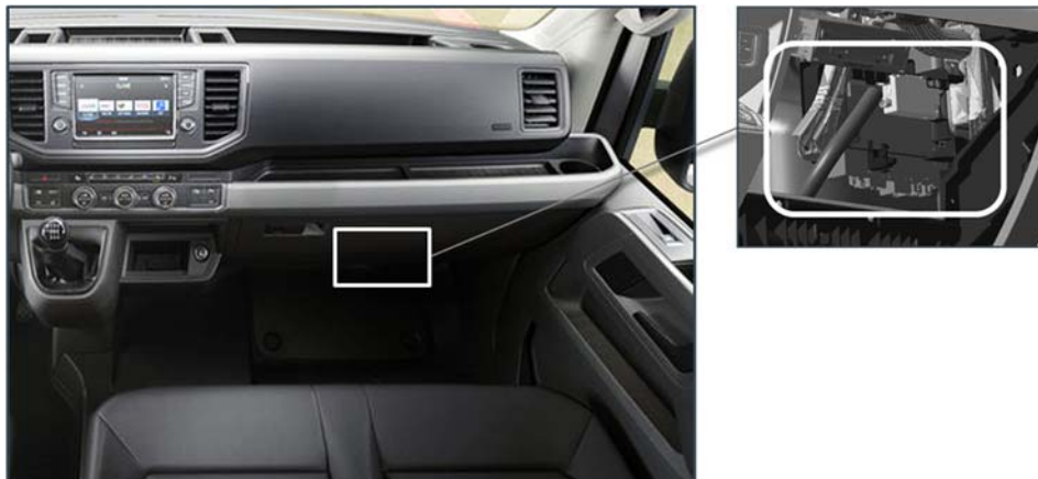
Montážní poloha KFG na přístrojové desce vpravo
