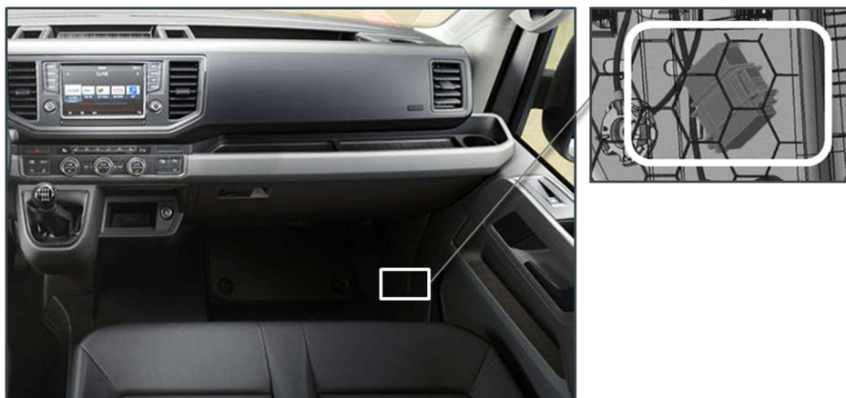
Svorkovnice (IS1) za obložěním A sloupku dole
