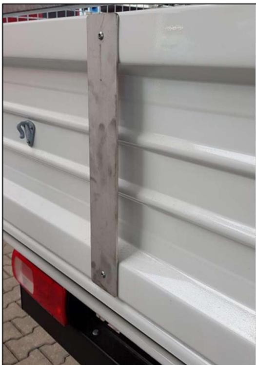
Obr. 3 „Stírací“ plech na zadní stěně sklápěče
