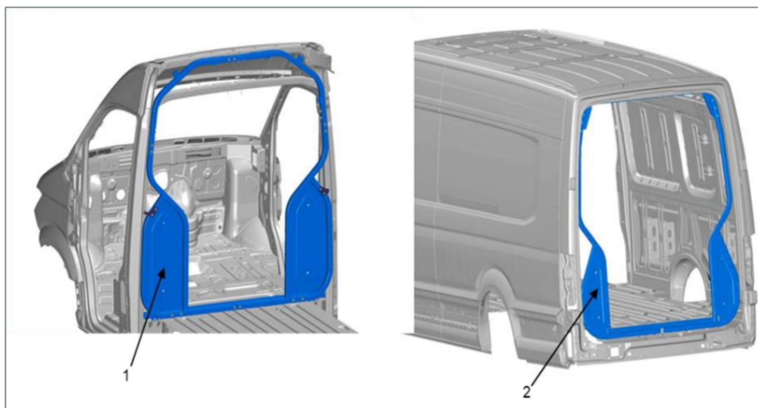
Obr. 1 Ochranný rám (PR č. 2Y1)
