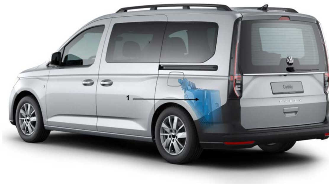
Obr. 1: Montážní poloha nádrže na AdBlue ve vozidle 1 Nádrž na AdBlue
