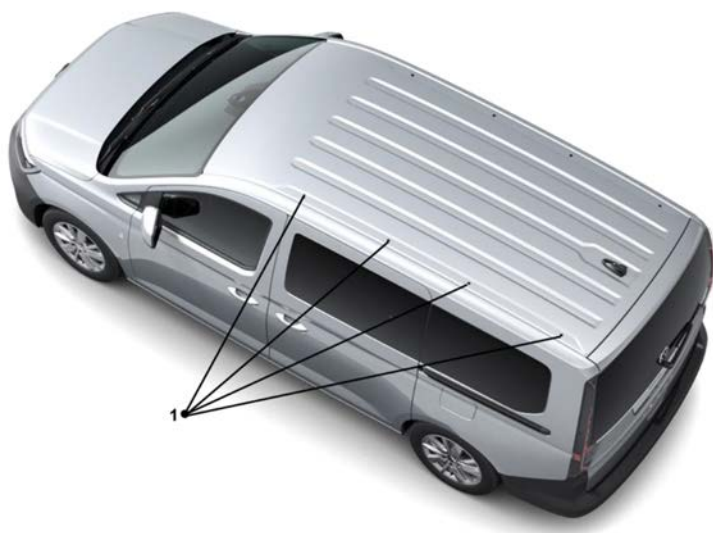
Obr. 2: Upevňovací body Caddy Maxi
