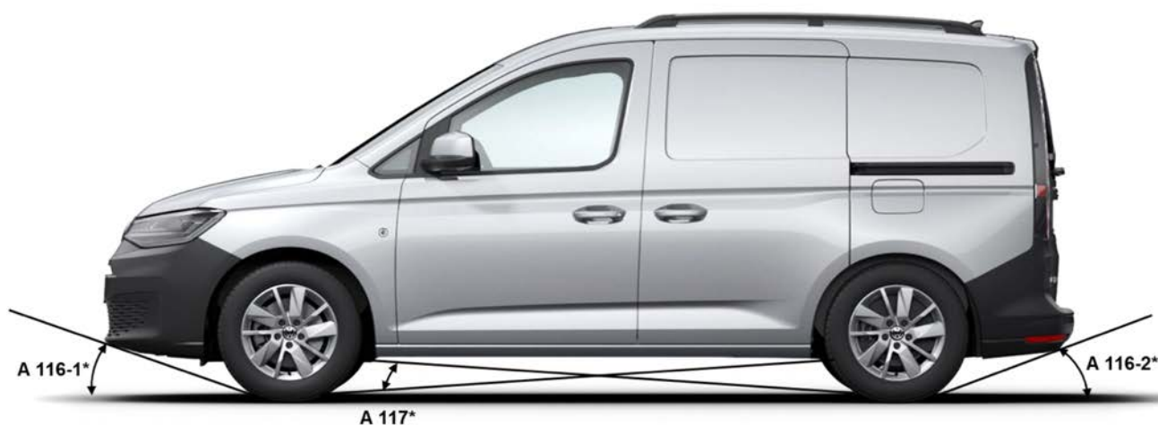
Obr. 1: Nájezdový úhel a přechodový úhel Caddy skříň
