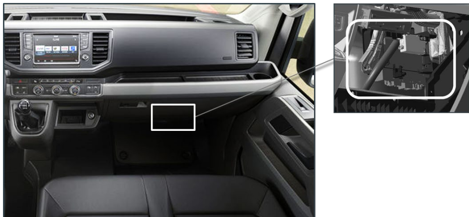
Montážní poloha KFG na přístrojové desce vpravo
