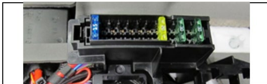
Obr. Detail: Držák pojistek – místo pro zapojení na druhý akumulátor
