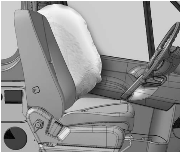
Prostor pro rozvinutí airbagu ve vozidle vlevo
