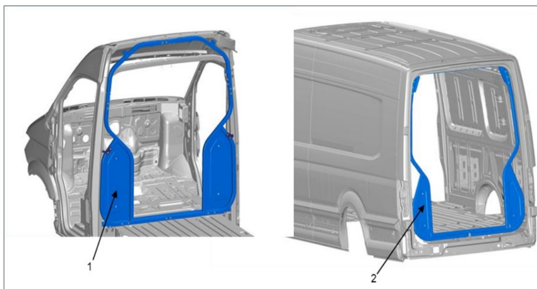
Obr. 1 Ochranný rám (PR č. 2Y1)
