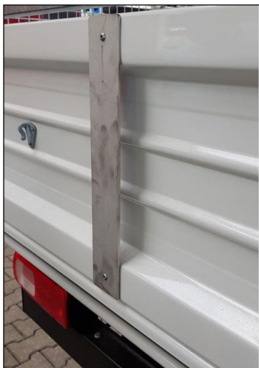
Obr. 3 „Stírací“ plech na zadní stěně sklápěče
