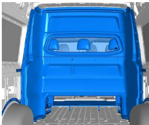
Obr. 2: Principiální schéma nastavby skříňového vozu o 3místnou lavici / 4místnou lavici ve 2. řadě sedadel. Pohled zezadu.
