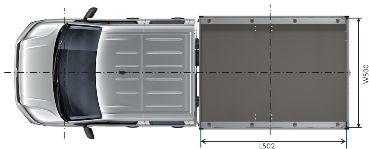
Obr. 2: Rozměry vozidla Doka – pohled na valník/střechu
