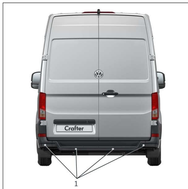
Obr. 2: Poloha ultrazvukových senzorů
