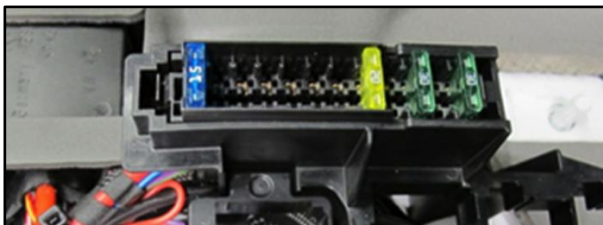
Obr. 3: Detail A: Držák pojistky– přejímací bod pro druhou baterii
