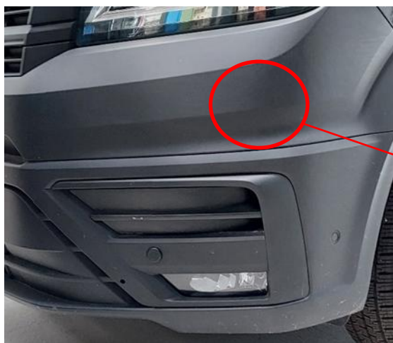
Obr. 3: Poloha radarových snímačů za krytem předního nárazníku
