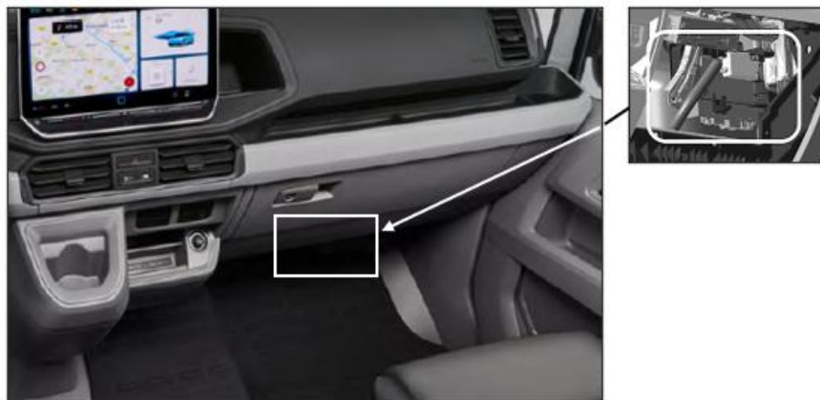
Montážní poloha KFG na spodní přístrojové desce, za přihrádkou před spolujezdcem
