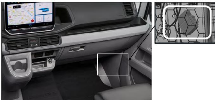
Svorkovnice (IS1) za obložením A-sloupku níže
