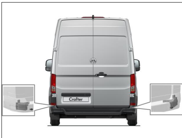
Obr. 1: Poloha radarových snímačů v zadním nárazníku
