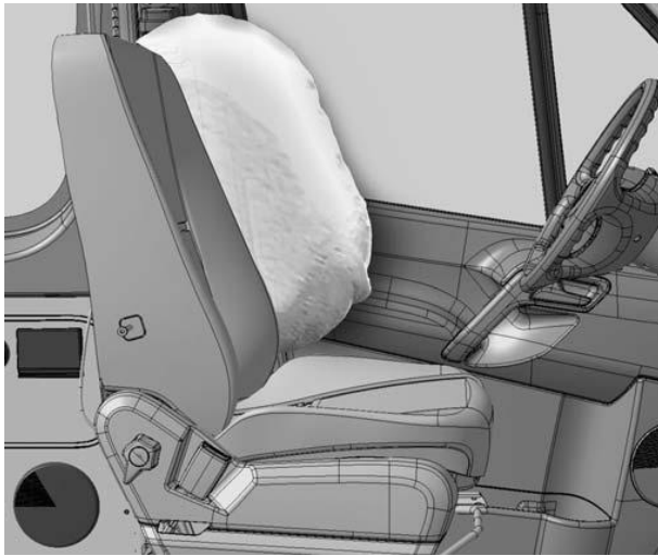
Obr. 1: Oblast nasazení hrudního vaku vlevo (hlavní obrázek!)
