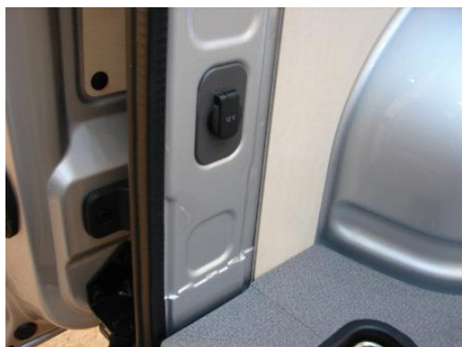
Obr. 2: Zásuvka 12 V na C-sloupku
