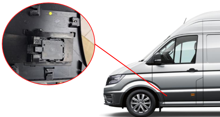
Obr. 3: Poloha radarových snímačů ve dveřích
