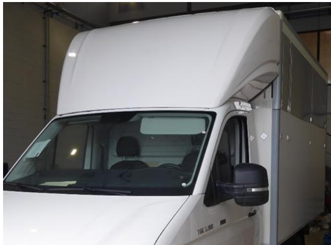
Obr. 1: Větrný deflektor/střešní spoiler na individuální kabině řidiče (schéma principu)
