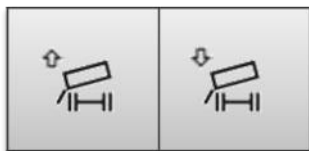
Obr. 2: Ovládací tlačítko ve vozidle (zvedání a spouštění)
