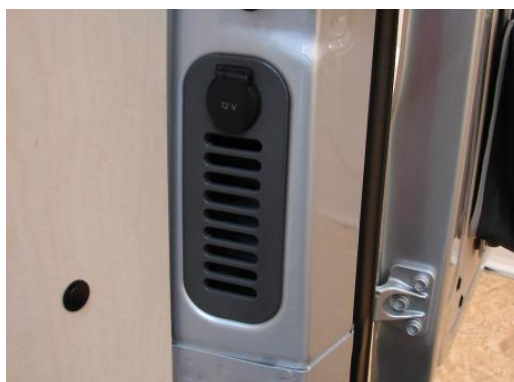
Obr. 3: Zásuvka 12 V na D-sloupku
