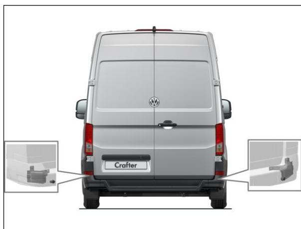
Obr. 3: Poloha radarových snímačů za krytem nárazníku vlevo a vpravo
