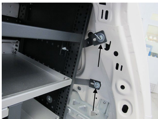
Obr. 5: Principiální schéma, pohled na šroubový spoj na vnitřní plech se stabilní vkladací deskou
