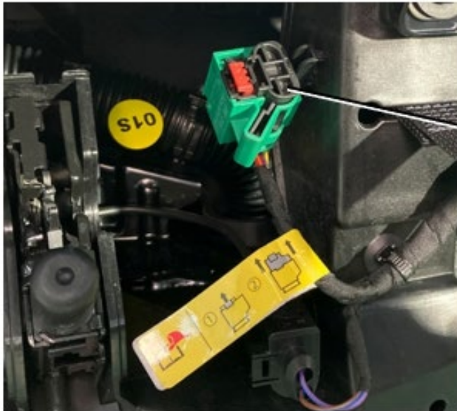
Obr. 2: udržovací zástrčka držáku zámku na pravé přední straně
