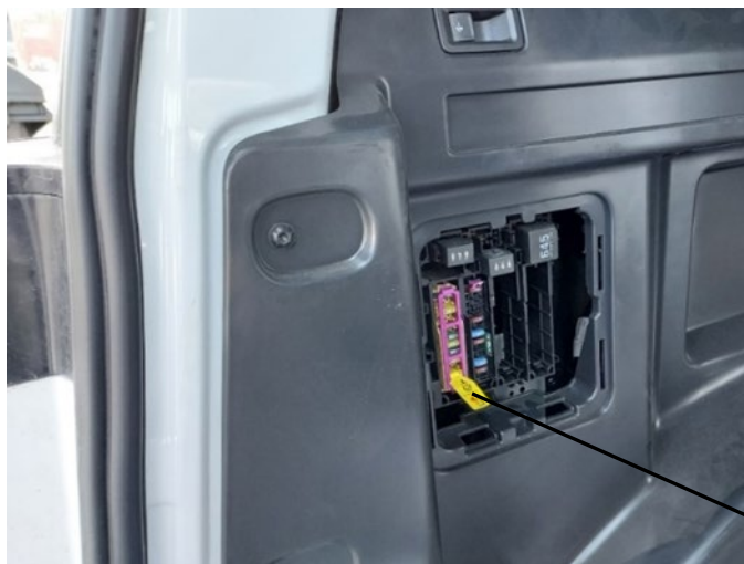
Obr. 1: Poloha držáku pojistek D v zavazadlovém prostoru vlevo za kapotáží
