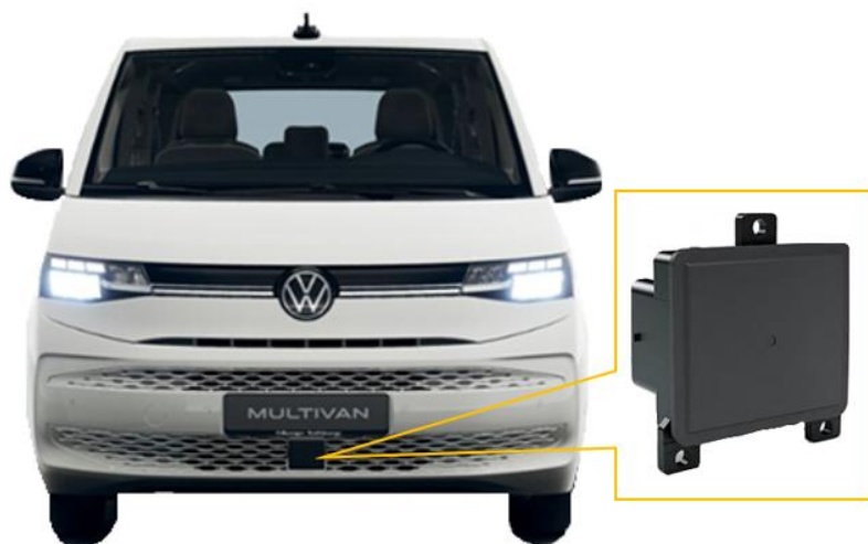
Obr. 5: Přední radarový snímač s tempomatem (umístěný za krytem ve spodní části nárazníku)
