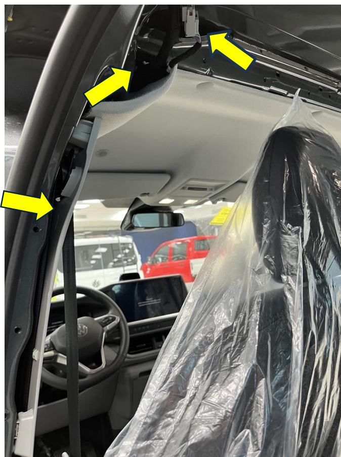
Obr. 1: Obklad sloupku B a střecha bez příčky
