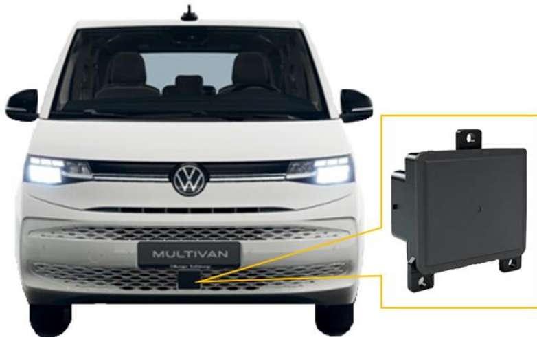
Obr. 6: Přední radarový senzor s adaptivním tempomatem (umístěným za krytem dole nárazníku)
